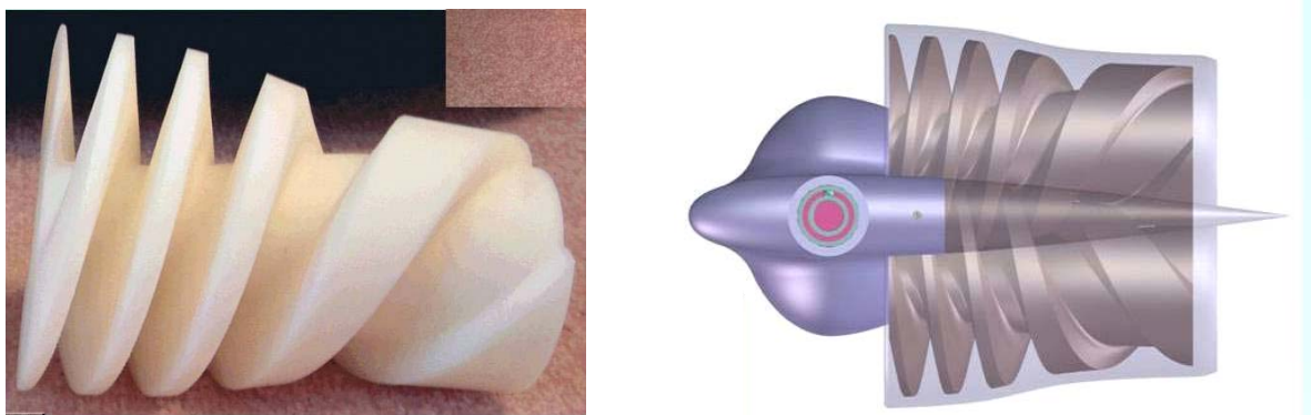
図 5. 新型プロペラの一つのらせん形シャフトと[組み立て]モデル
