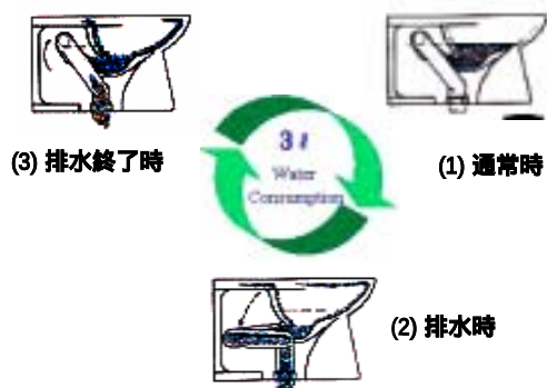
図3 柔軟な管を上げ下げする超節水トイレ
