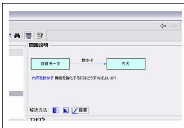
図 1 内刃を動かす速度が遅いの物質-場モデル
